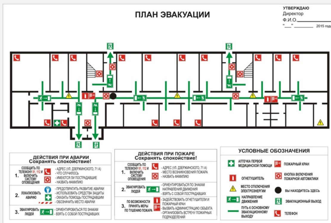
Рисунок 1. Схема аварийных проходов и выходов (схема эвакуации)
